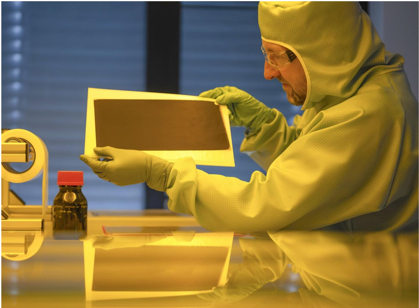
Das Freiburger Start-up Ionysis entwickelt PFAS-freie Membranen für Brennstoffzellen. Die schwarze Schicht enthält eine Katalysatormischung, die die Stromproduktion aus Wasserstoff und Sauerstoff fördert.
